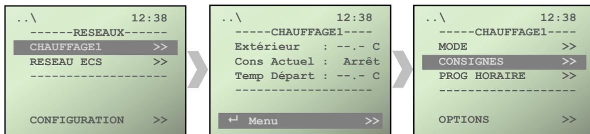
Exemple de représentation du menu "CONSIGNES" en mode de régulation "AUTO" et configuration "CONFIGURATION" en commande "3Points".
